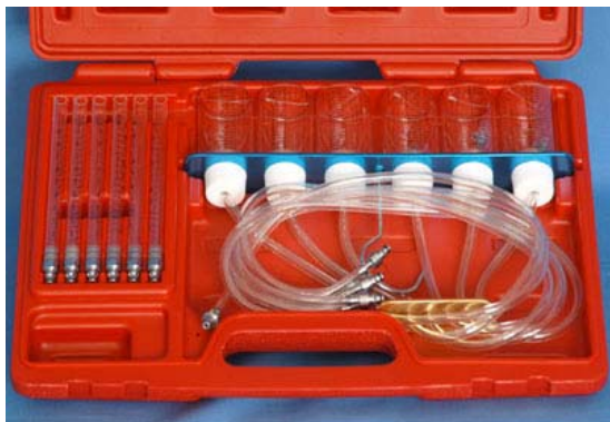
Pajisje për diagostikimin e sasisë së lëndës djegëse që del nga injektorët
